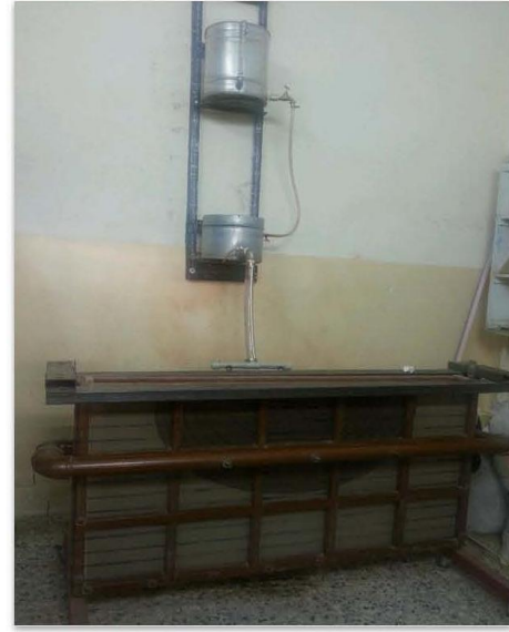
الشكل (1) : حاوية التربة ومنظومة تجهيز الماء.
